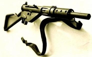
**Pistolet mitrailleur britannique de type «Sten» (modèle MK II) à culasse percuteuse non calée.**
